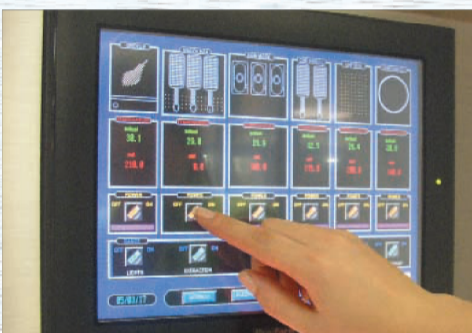
Touchscreen met extra back-up besturing op iedere ketel, dus ook bij storing kunt u gewoon doorbakken.
