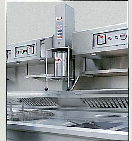
Eingebauter RAS-Pommesfrites Apparat.
