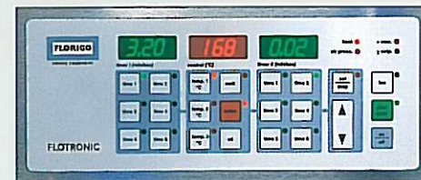
Digitale thermostaatregelingen voor bakplaat, au bain marie, frites-uitschepbox.
