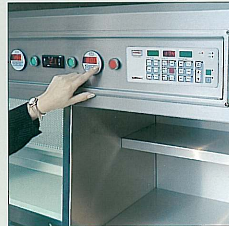
Digitale thermostaatregelingen voor bakplaat, au bain marie, frites-uitschepbox.
